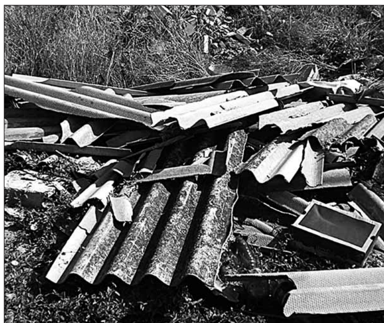
Lastre di amianto abbandonate nelle campagne
